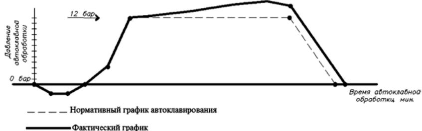
Рис. 4. График автоклавирования газобетонов, изготовленных на кварц-полевошпатовом песке
