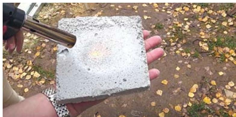
Рис. 4. Воздействие газовой горелки на образец ЛСПБ.
