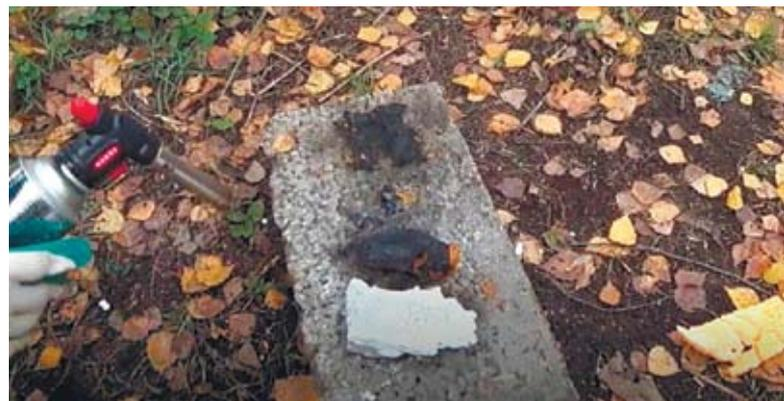
Рис. 3. Показаны четыре образца разного вида утеплителя после воздействия на них открытым пламенем из газовой горелки в течение 30 секунд.
