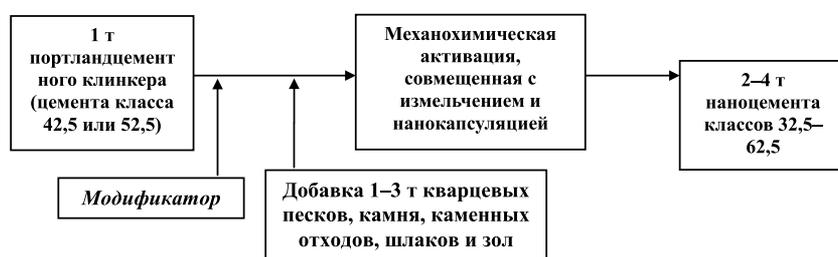
Рис. 2. Принципиальная схема производства малоклинкерных нанощементов
