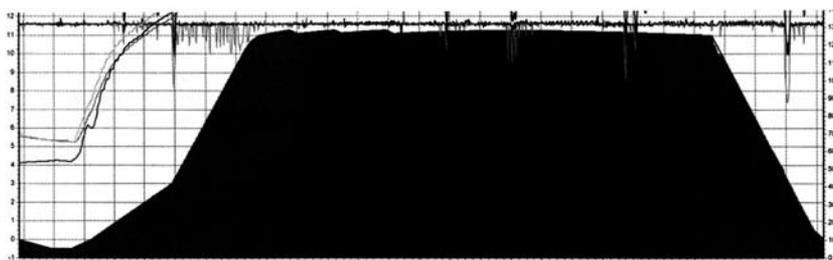
Рис. 2. График автоклавирования газобетона марки D 500
