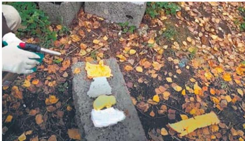
Рис. 2. Четыре образца утеплителя до воздействия газовой горелки.
