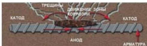
Рис. 1. Коррозия арматуры в бетоне
