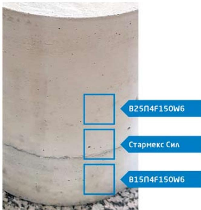
Рис. 2. Внешний вид образца до начала испытаний
