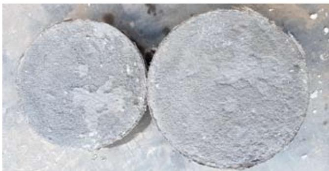
Рис. 6. Образец, расколотый в продольном направлении (по покрытию «Стармекс Сил»)
