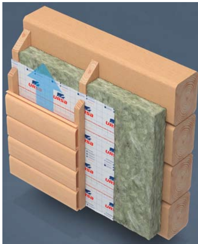
Рис. 1. Конструкция дополнительного утепления наружных стен из бруса. Слева-направо: сайдинг, вентилируемый воздушный зазор, ветрозащитная мембрана, теплоизоляция, установленная в каркас, стена из бруса
