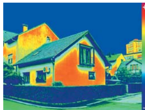
Рис. 2. Тепловизионный снимок дома.
