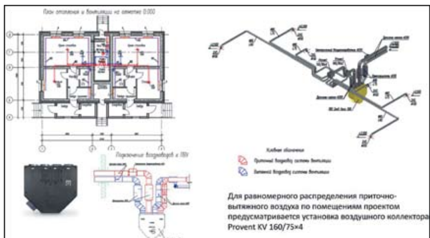
Рис. 7. Пример сблокированного 4-х квартирного дома с механической приточно-вытяжной системой с рекуперацией тепла TURKOV ZENIT HECO 450.
