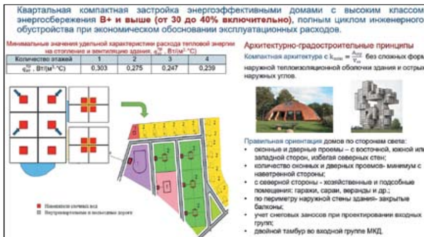
Рис. 3. Способы достижения высокого класса энергосбережения при проектировании МЖК в климатических условиях Арктики.
