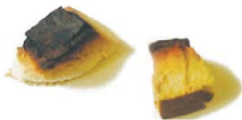
Теплоизоляция из ППУ после 1года эксплуатации
