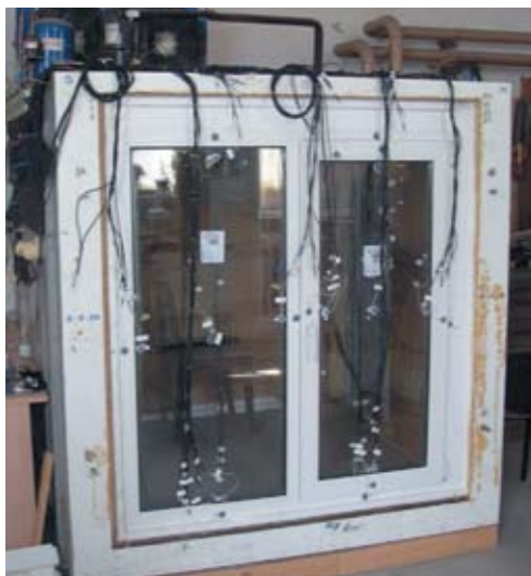
Рис. 4. Испытание оконной конструкции в климатической камере.
