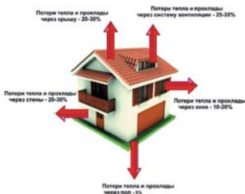
Рис. 1. Примерное распределение потерь тепла и холода в стандартном здании.
